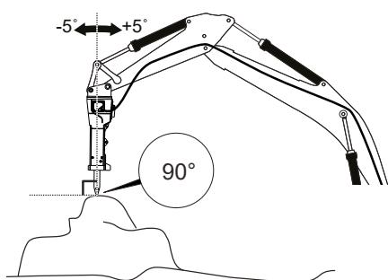
To bo omogočilo odvajanje prahu pod konico delovnega orodja. Sicer se lahko ustvari sloj prahu, ki preprečuje polni izkoristek udarne energije v material. Konica delovnega orodja se tedaj segreje in izgubi trdnost.
