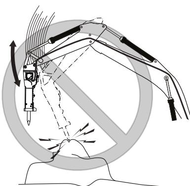
To bo povzročilo poškodbe hidravličnega kladiva, delovnega orodja in nosilca.
