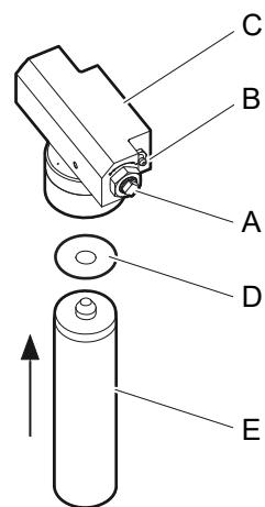
Črpalka (C) mora biti vedno zaprta, da preprečimo vdor vlage in prahu.
