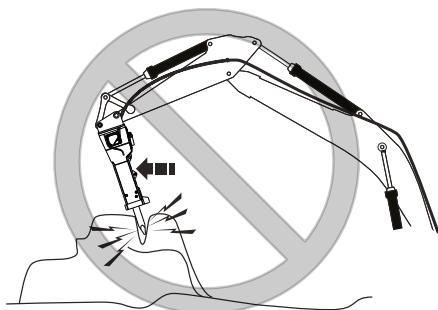
To lahko povzroči pok delovnega orodja. Poslušajte zvok hidravličnega kladiva - če se med delovnim orodjem in pušo vzpostavi napetost, se zvok delovanja spremeni.
