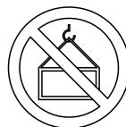
Nikoli ne dvigujte hidravličnega kladiva s transportno varnostno napravo. Slednja ni namenjena dviganju in se lahko zlomi, pri čemer povzroči padec hidravličnega kladiva.
